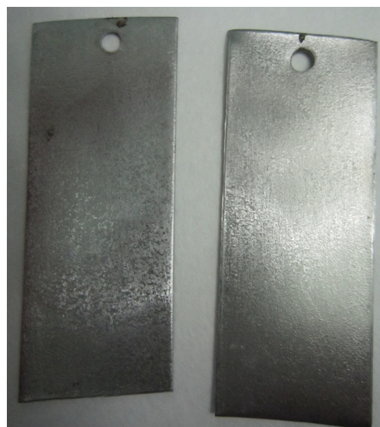
Рис.20. Внешний вид образцов для гравиметрии после 100 ч испытаний при 75°C в деаэрированной воде с 1% ингибитора АБ
