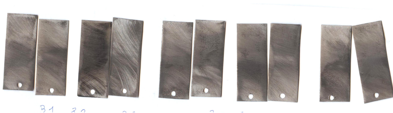
Рис.3. Внешний вид образцов для гравиметрии перед коррозионными испытаниями
