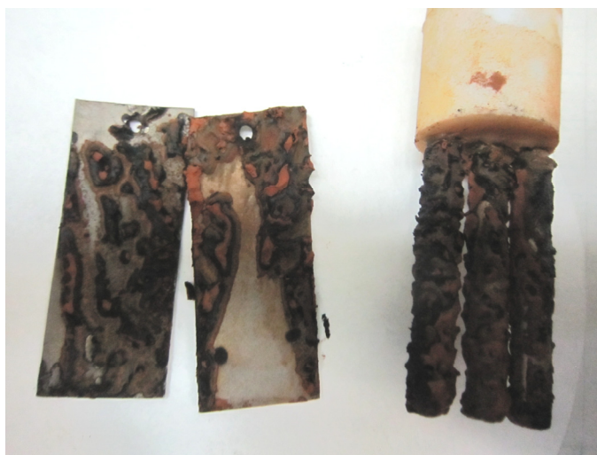
Рис. 13.. Внешний вид образцов для гравиметрии и датчика ЛПС после 100 ч испытаний при 75°С в азрированной воде (фон) с перемешиванием (барботаж)
