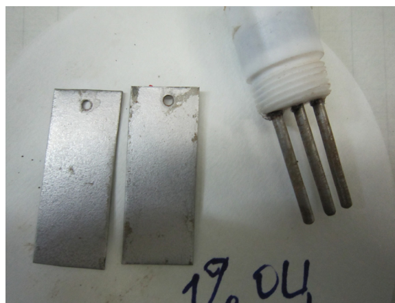
Рис.17. Внешний вид образцов для гравиметрии и датчика ЛПС после 100 ч испытаний при 75°C в аэрированной воде, содержащей 1% ингибитора ОЦ
