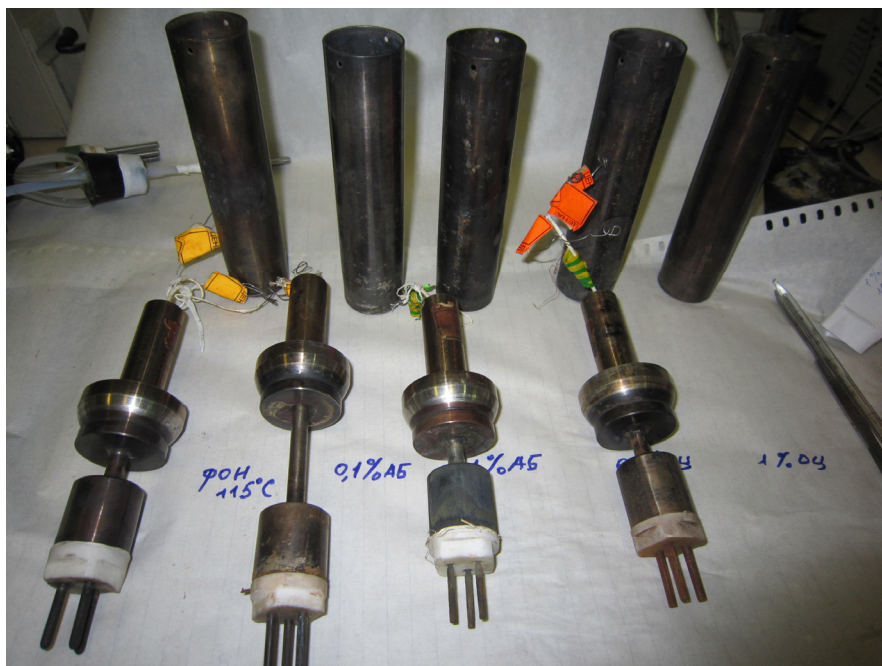
Рис.5. Стаканы для автоклавов и электрохимические трехэлектродные датчики для проведения автоклавных коррозионно-электрохимических испытаний в воде при 115^{\circ}\text{C}
