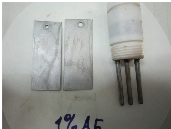
Рис.15. Внешний вид образцов для гравиметрии и датчика ЛПС после 100 ч испытаний при 75°C в аэрированной воде с перемешиванием, содержащей 1% ингибитора АБ
