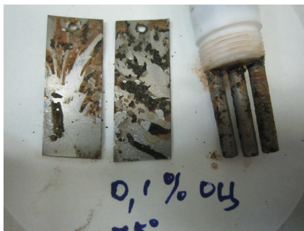
Рис.16. Внешний вид образцов для гравиметрии и датчика ЛПС после 100 ч испытаний при 75°C в аэрированной воде с перемешиванием, содержащей 0,1% ингибитора ОЦ
