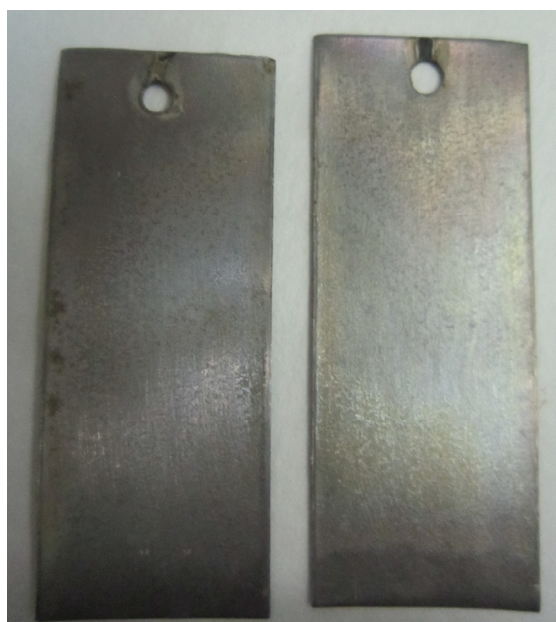
Рис.19. Внешний вид образцов для гравиметрии после 100 ч испытаний при 75°C в деаэрированной воде без перемешивания с 0,1% ингибитора АБ
