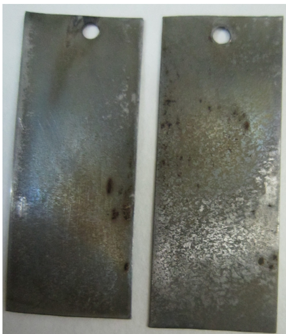
Рис. 18. Внешний вид образцов для гравиметрии после 100 ч испытаний при 75°C в деаэрированной воде без перемешивания и без ингибиторов (фон)
