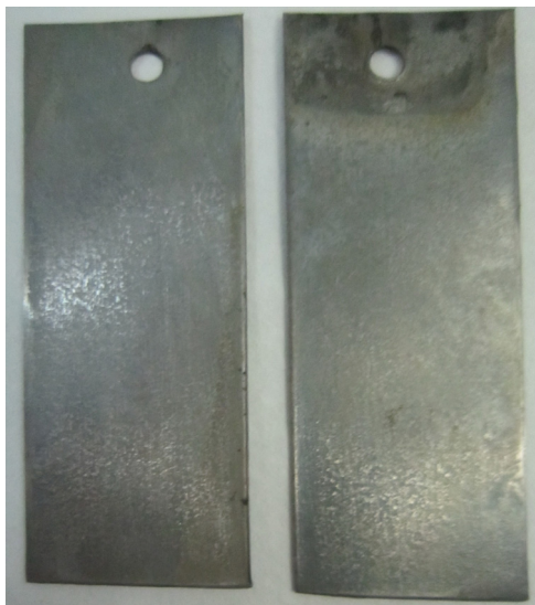
Рис. 21. Внешний вид образцов для гравиметрии после 240 ч испытаний при 75°C в деаэрированной воде с 0,1% ингибитора ОЦ
