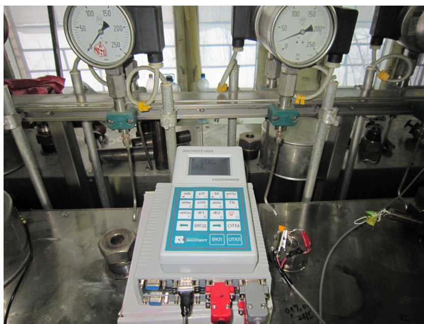
Рис.6. Измерение коррозионных показателей стали Ст3 при проведении автоклавных испытаний с помощью автоматического коррозиметра «Эксперт-004» с коммутатором
